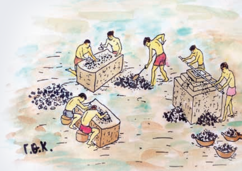
Θραύση μεταλλεύματος σε λίθινες τράπεζες Crushing of the ore on stone tables
